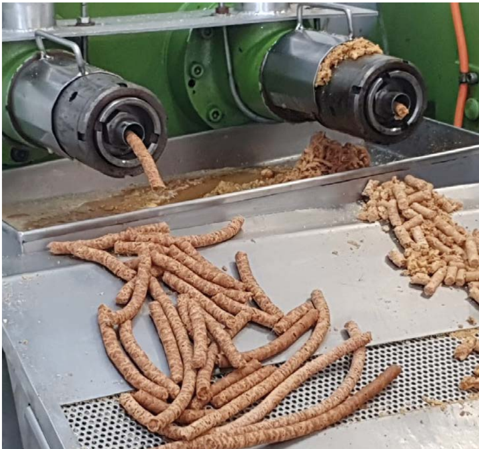
Les déchets de pression des graines sont utilisés pour faire du charbon actif.
