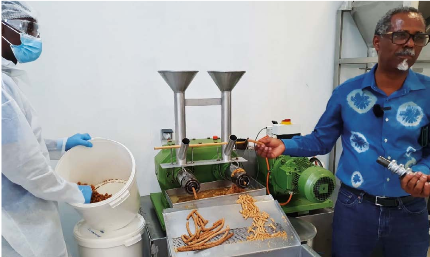
La machine spéciale créée pour Phytobokaz pour extraire l'huile des graines de galba.
